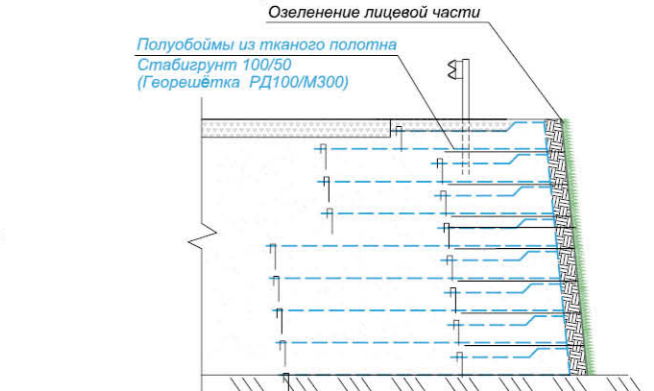
Армогрунтовая подпорная стена по методу обёртывания с озеленением лицевой части
