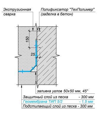
Узел 3 Примыкание Бентотех АСЛ 100 к бетонной конструкции
