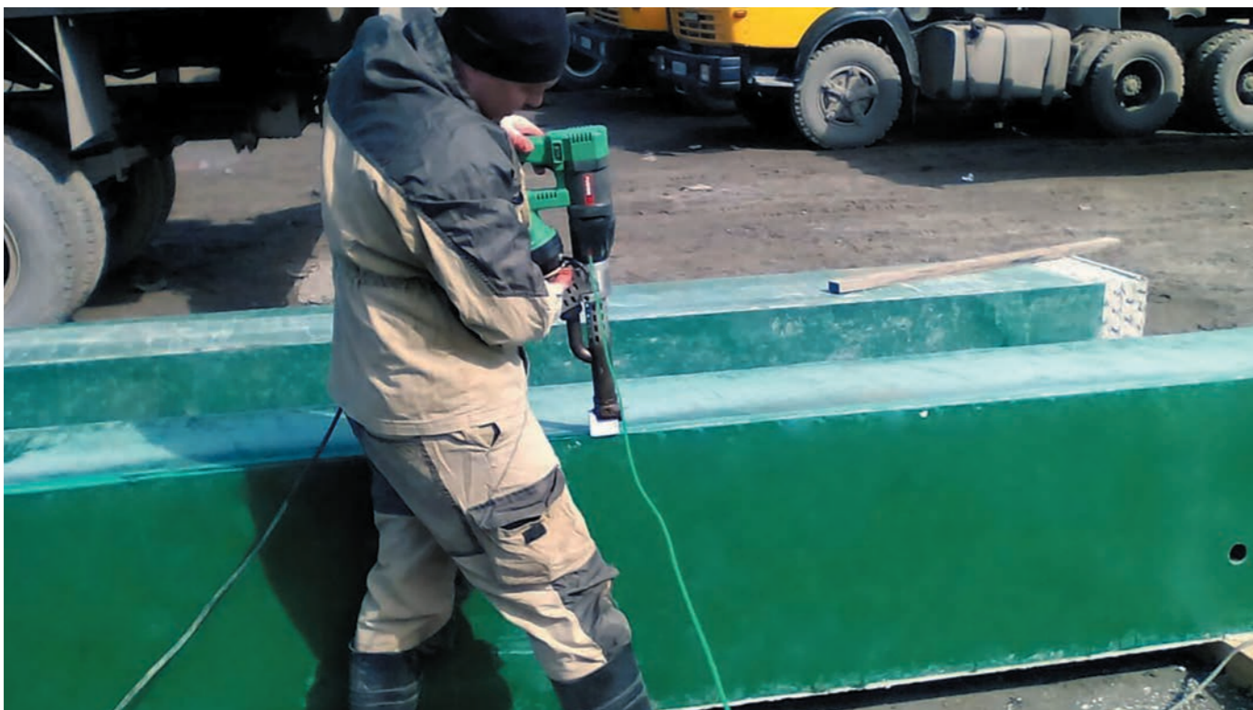
5. Проварка углов экструдером
