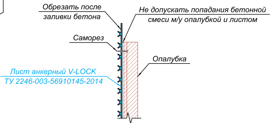
Крепление анкерного листа V-LOCK к верху опалубки Вариант 2
