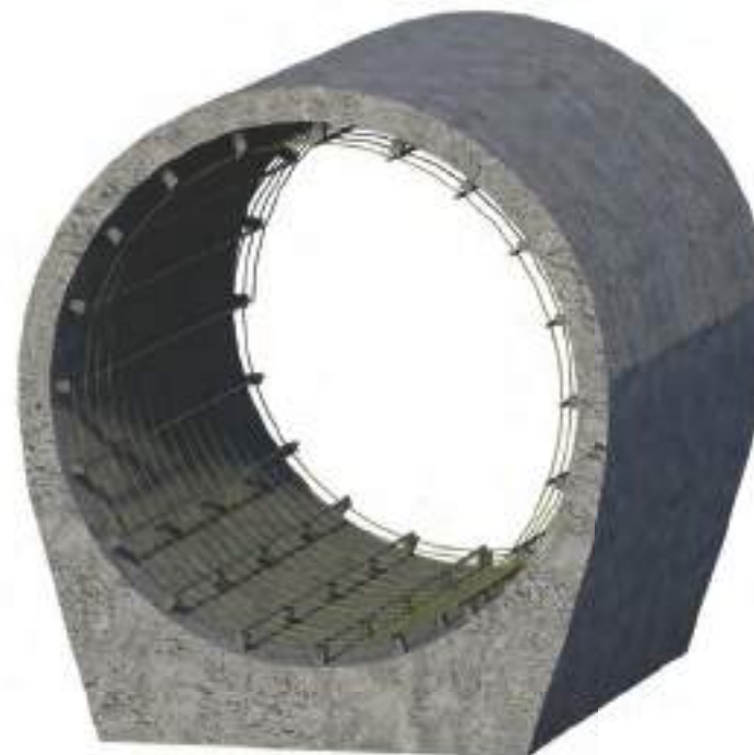
Водопропускная труба D = 1,25 м Усиленный арматурный каркас
